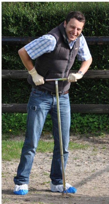
*Photographie n° 40: La portion de la terre, située au milieu du tourne à gauche, est poussée dans un pilulier avec des gants à usage unique*
