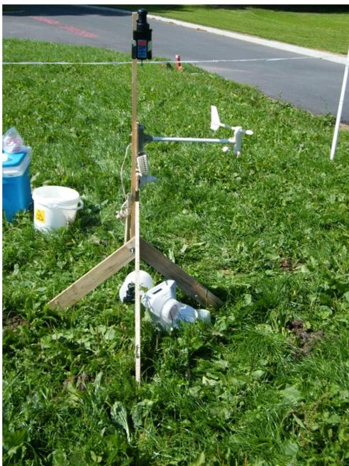
Photographie n° 18: Fermeture du crible de l'Air idéal® 3P avant le prélèvement à la hauteur de 15 cm
