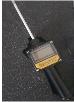
Figure 11 : photographie de la sonde Draminsky (un ohmètre) utilisée au cours de l'étude
