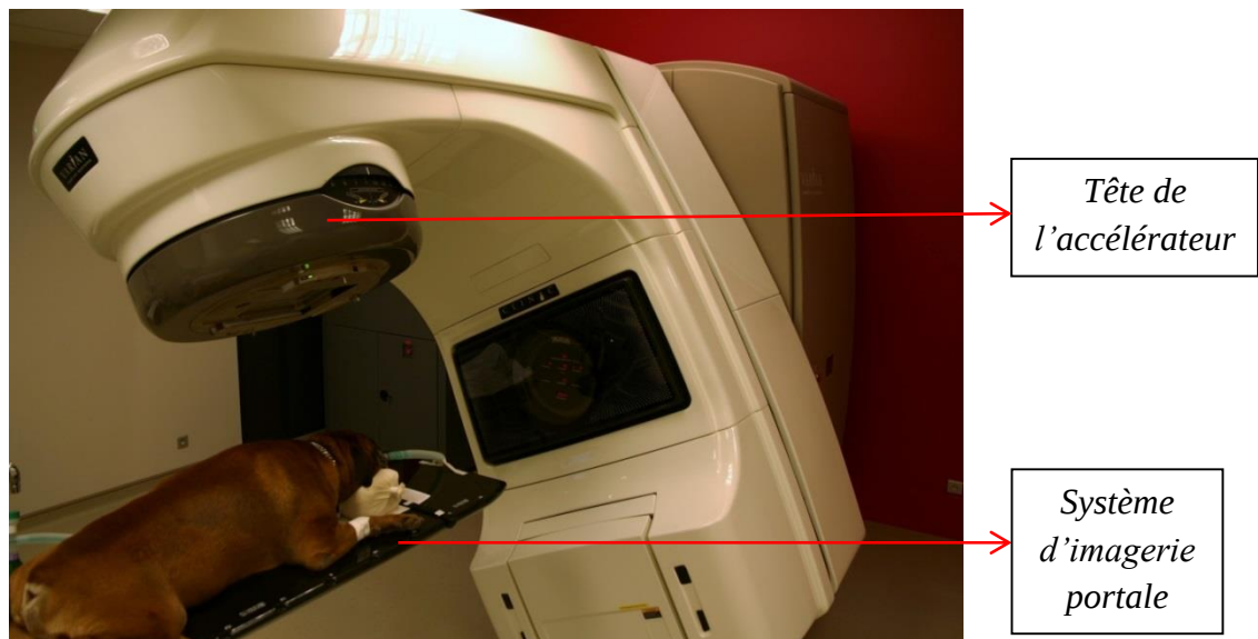
Figure 5 : Un accélérateur linéaire de particules
