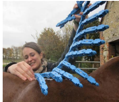
Figure 75 : Mise en place du topographe. Etape (2) : placement du topographe à partir de T18
