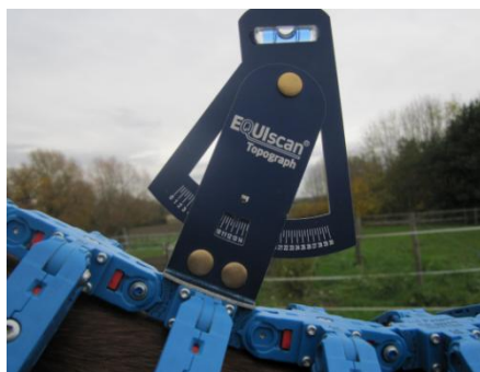
Figure 77 : Etape (4) : relevé de l'angle au niveau du 4° segment
