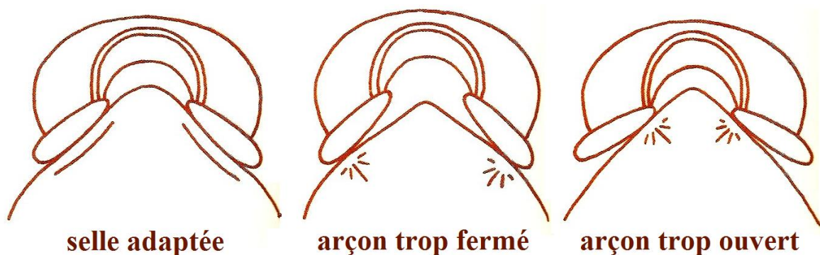
Figure 45 : Influence de l'angle d'ouverture de l'arçon sur la répartition des pressions sur le dos du cheval. D'après RIESER (2008)
