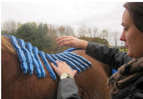
Figure 76 : Mise en place du topographe. Etape (3) : verrouillage du topographe
