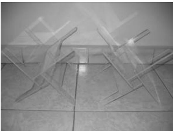
Les ailettes des bobines ont été par la suite raccourcies car elles étaient trop fragiles et des ailettes plus courtes suffisaient à contenir tout le fil (figure 32). De plus, j'ai cerclé les bobines avec du fil de fer gainé pour rendre l'ensemble encore plus solide ; en effet les 4 parties constituant chaque bobine étaient uniquement collées et emboîtées à l'origine.
