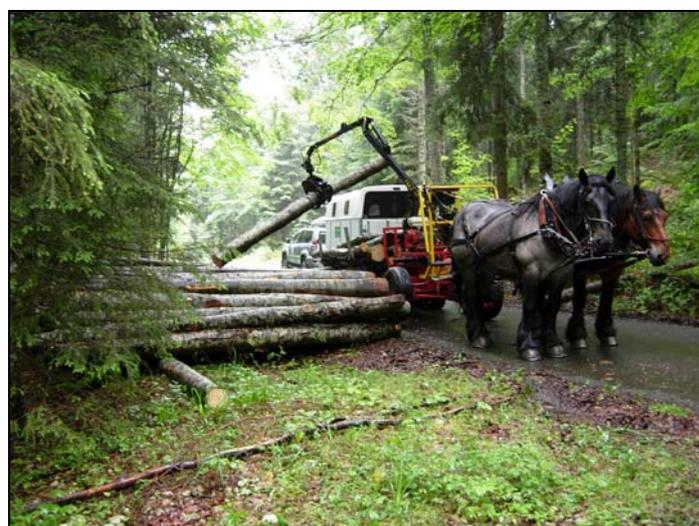
La pression qu'exerce ce matériel sur le sol passe de 0,3 bar à vide à 1,3 bar en charge maximale. Les roues, qui ne sont pas motrices, ne scalpent pas la couche supérieure du sol. Le porteur hippomobile permet ainsi de sortir des bois billonnés sans causer de dégâts, même dans un sous-bois assez dense.
