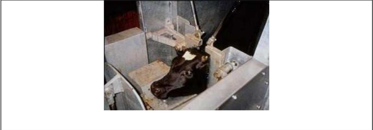
Dans le système néo-zélandais, le courant passe de l'étauçonnage enserrant le cou à une plaque disposée sous le museau.
