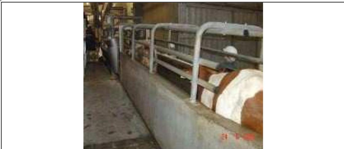
Afin de faciliter l'avancée des bovins jusqu'au poste d'assommage, la fin du couloir d'amenée devrait être en courbe ascendante et se terminer par un couloir sombre. L'éclairage du poste d'étourdissement incitera alors le bovin à pénétrer dans le piège (Figure 21), d'après LEMOINE *et al.* (71).
