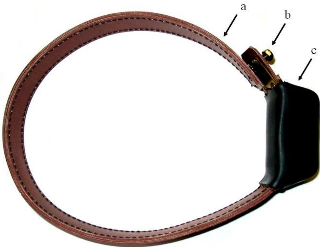
a) collier en cuir ; b) fermoir en métal ; c) unité émettrice VHF.
